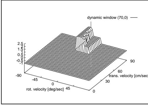
Figure 13. Objective function for actual velocity (75,0)
